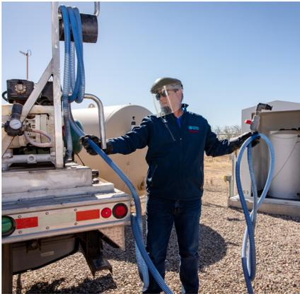
Tucson Water mide continuamente los niveles de desinfectante residual de cloro para asegurar que no excedan el límite máximo de desinfectante residual. Utilizamos estaciones de muestreo ubicadas a través del sistema de distribución para coleccionar 268 muestras rutinarias de cloro al mes, y recolectamos muestras microbiológicas al mismo tiempo.
